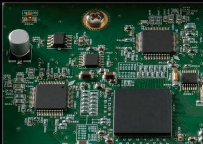
测量部分采用高分辨率 A/D 转换器。通过控制输入信号的电平和频率，可以充分利用 A/D 转换器的动态范围，实现宽量程范围的阻抗测试和最小偏差的测量。
