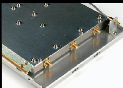
各部分均采用贴合基板上的式样和 IC 形状的固定保护板，减少内部相互接触。此外，对于外部辐射的降低和抗干扰性能提高等方面，在机身做到最轻量级别的同时也满足 EMC 的高标准。
